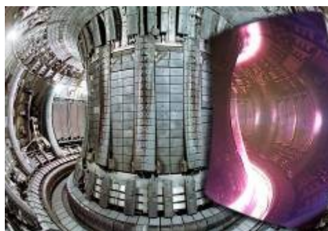
Rys. 2. Widok wnętrza komory tokamaka JET. (Po lewej widok komory w czasie wyładowania).
